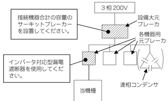
インバータ使用機種に進相コンデンサは取付けないでください。
