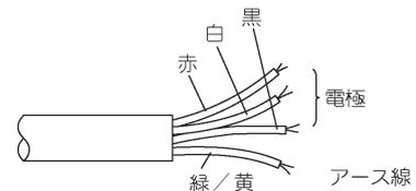
(注) アースについては、D 種接地工事 (第 3 種接地工事) が法規で義務づけられています。
