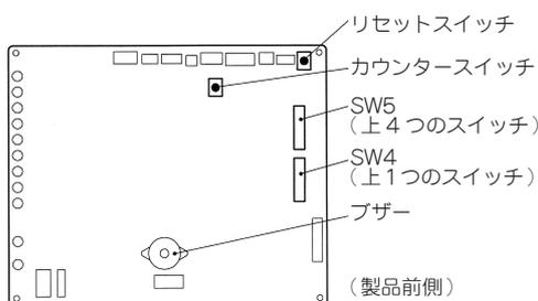
図-19 制御基板
