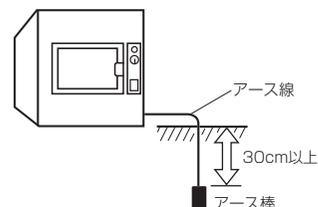
法令により電気工事士によるD種接地工事が必要です。
