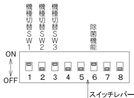
図10 制御基板 SW1
