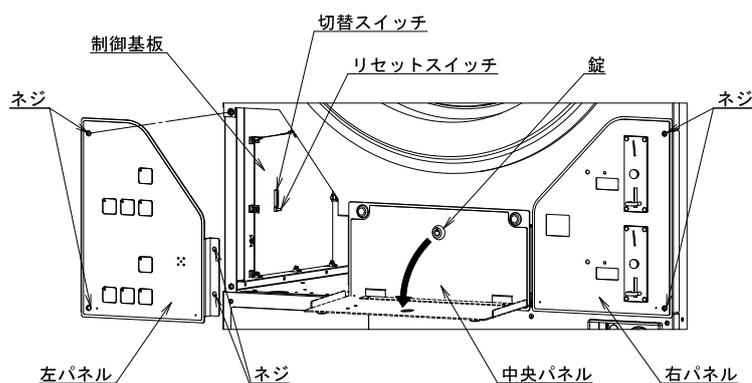
図 - 17 操作板と制御基板
