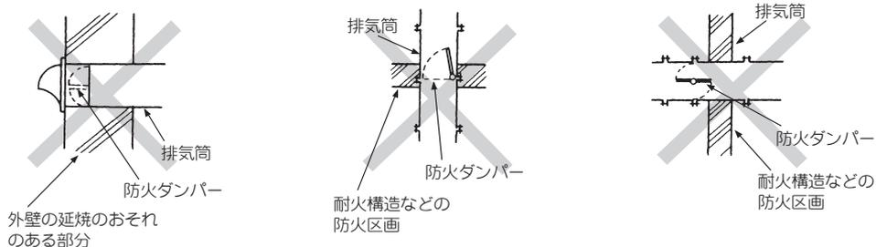
図-11 防火ダンパー取り付け禁止の例
