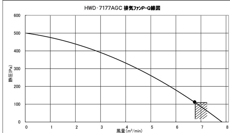
● で表した点が20m配管時のものです。風量がこの点よりも大きくなる様な排気筒長さ(斜線部の風量)でご使用ください。
