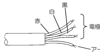
(注)アースについては、D種接地工事(第3種接地工事)が法規で義務づけられています。
