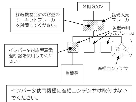
インバータ使用機種に進相コンデンサは取付けないでください。
