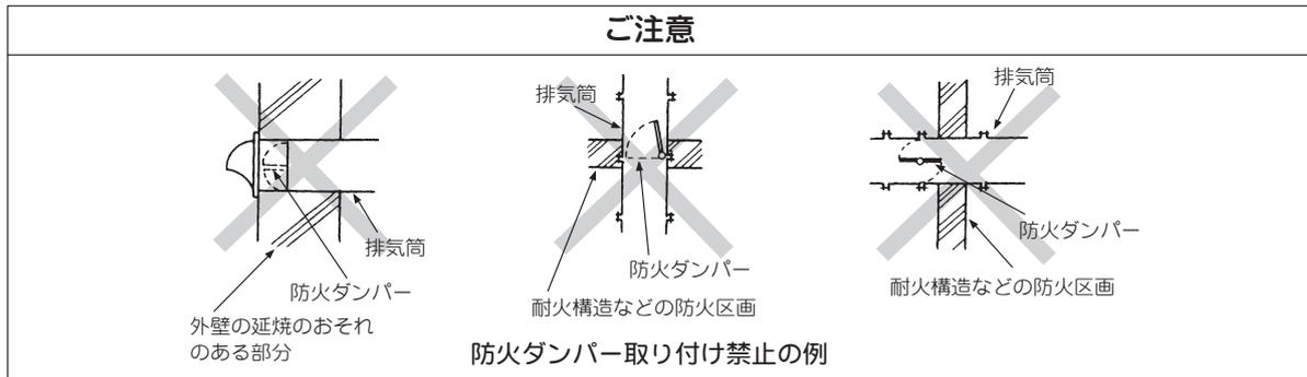
防火ダンパー取り付け禁止の例
