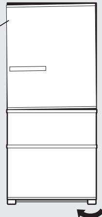
転倒防止用のベルトをかける背面のフックにベルトを通して、壁や柱に固定する
