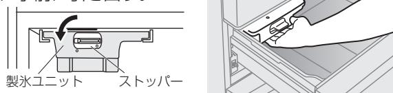
※自動製氷機は、氷ができると製氷皿をひねって氷を落とす動作をします。はずしたとき、製氷皿がひねられている場合は、いったん製氷ユニットを所定の位置に戻して、冷凍室扉を閉め、製氷皿がまっすぐになるまで待ってから（約1分後）、製氷ユニットをはずしてください。
