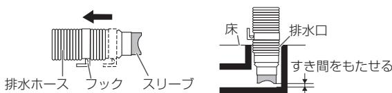
排水ホースは排水時の水の力や振動などで動く場合があるため、排水口にしっかりと差し込み、抜けないことを確認してください。
