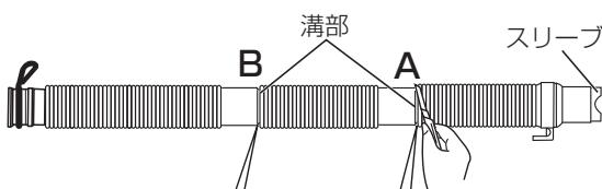
本体と洗濯パンなどの排水口の距離に応じて、溝部2ヶ所A・Bのうち、どちらかの溝部を切って先端にスリーブをはめ直してください。
