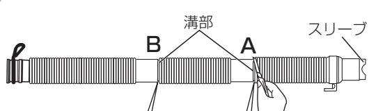
本体と排水口の距離に応じて、溝部2ヶ所A・Bのうち、どちらかの溝部を切って先端にスリーブをはめ直してください。
