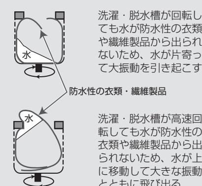
洗濯・脱水槽が高速回転しても水が防水性の衣類や繊維製品から出られないため、水が片寄つて大振動を引き起こす
