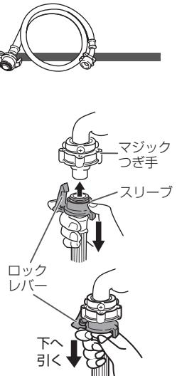
ロックレバーと本体が接触しない位置で取り付けてください。(水もれの恐れ)
