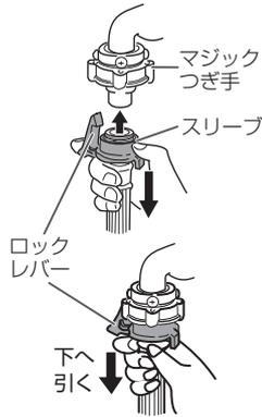
ロックレバーと本体が接触しない位置で取り付けてください。(水もれの恐れ)
