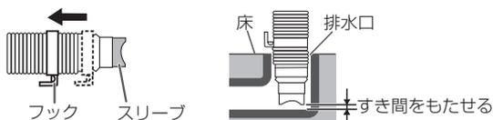
排水ホースは排水時の水の力や振動などで動く場合があるため、排水口にしっかり差し込み、抜けないことを確認してください。
