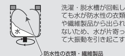
洗濯・脱水槽が回転しても水が防水性の衣類や繊維製品から出られないため、水が片寄って大振動を引き起こす
