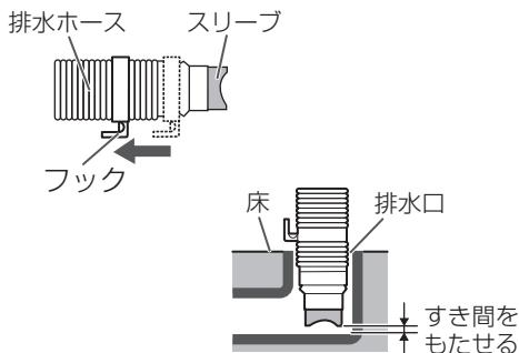
排水ホースは、排水時の水の力や振動などで動く場合がありますので、排水口にしっかり差し込み抜けないことを確認してください。
