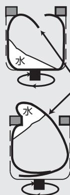
洗濯・脱水槽が回転しても水が防水性の衣類や繊維製品から抜けられないため、水が片寄って大振動を引き起こす
