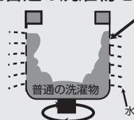
洗濯物の水は洗濯・脱水槽の穴から抜け出る
