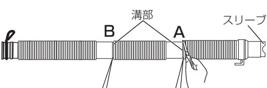
本体と洗濯パンなどの排水口の距離に応じて、溝部2ヶ所A・Bのうち、どちらかの溝部を切って先端にスリーブをはめ直してください。
