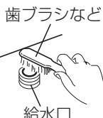
**7 袋ナットを傾きのないように確実に締め付ける**
