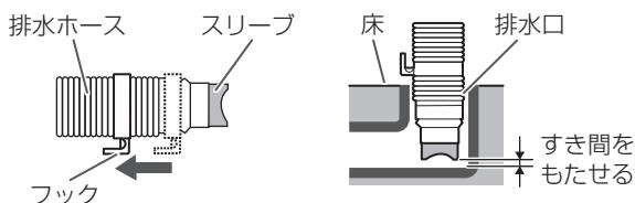
排水ホースは、排水時の水の力や振動などで動く場合がありますので、排水口にしっかり差し込み抜けないことを確認してください。
