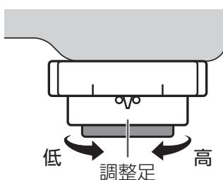
2 ピンをはずして矢印方向にロックナットを回して固定する
