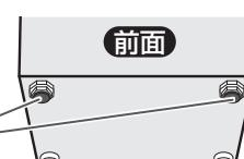
5 本体上端の対角(右前・左後および左前・右後)を押させて、ガタつきがないか確認する
