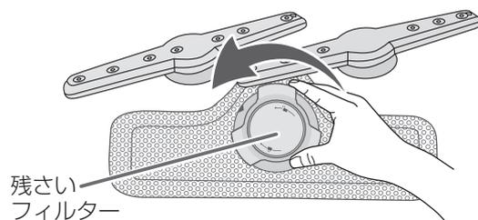
3. 残さいフィルターの上下を持ち、時計回りに回して外します。
