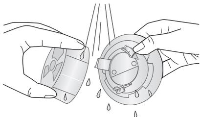
残さいフィルターの上下を持ち、反時計回りに回して組み付けます。
