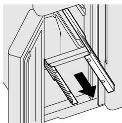
**2** 両手でボックスを持ち、レールの奥の穴にボックスのツメを入れ、ボックスをゆっくり下におろしながら、レールの手前の穴にボックスのロック形状を入れる。
