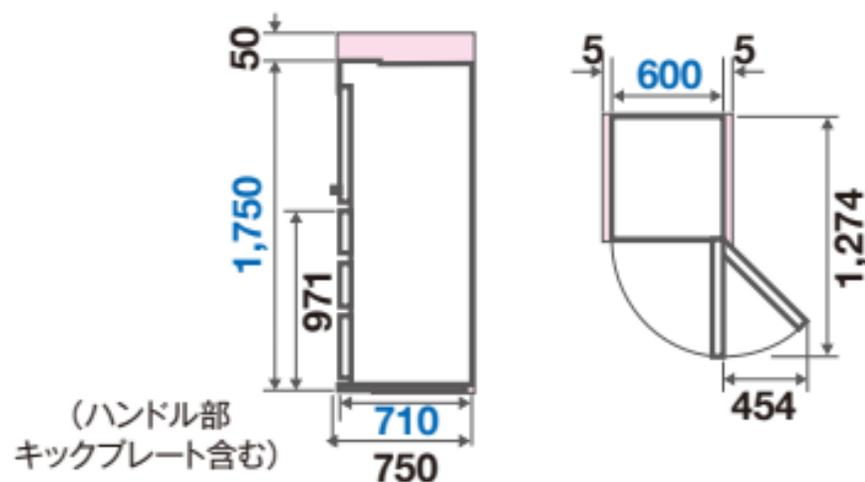
■外形寸法:幅600×奥行710×高さ1,750mm
