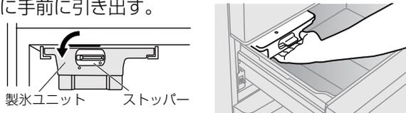
※自動製氷機は、氷ができると製氷皿をひねって氷を落とす動作をします。はずしたとき、製氷皿がひねられている場合は、いったん製氷ユニットを所定の位置に戻して、冷凍室(上)扉を閉め、製氷皿がまっすぐになるまで待ってから(約1分後)、製氷ユニットをはずしてください。
