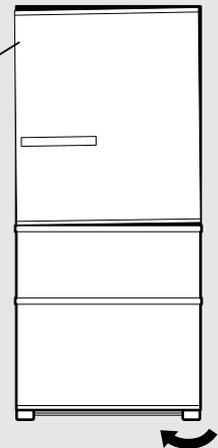
転倒防止用のベルトをかける背面のフックにベルトを通して、壁や柱に固定する
