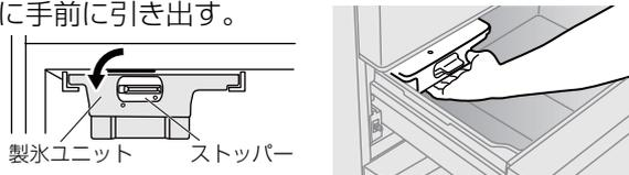
※自動製氷機は、氷ができると製氷皿をひねって氷を落とす動作をします。はずしたとき、製氷皿がひねられている場合は、いったん製氷ユニットを所定の位置に戻して、冷凍室扉を閉め、製氷皿がまっすぐになるまで待ってから(約1分後)、製氷ユニットをはずしてください。
