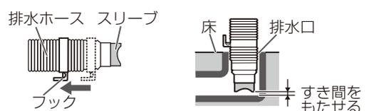
排水ホースは、排水時の水の力や振動などで動く場合がありますので、排水口にしっかり差し込み抜けを確認してください。
