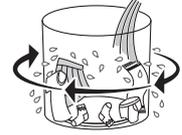
洗濯・脱水槽をゆっくり回し、給水と排水を同時に行いすすぎます。
