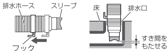
排水ホースは、排水時の水の力や振動などで動く場合がありますので、排水口にしっかり差し込み抜けしないことを確認してください。
