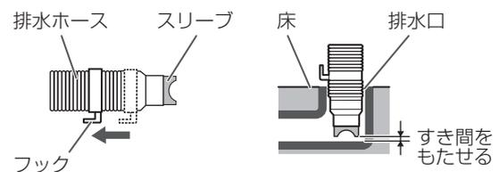
排水ホースは、排水時の水の力や振動などで動く場合がありますので、排水口にしっかり差し込み抜けないことを確認してください。
