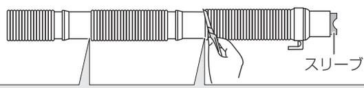
本体と排水口の距離に応じて、2カ所のうち、どちらかを切って先端にスリーブをはめ直してください。
