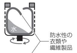
洗濯・脱水槽が高速回転しても水が防水性の衣類や繊維製品から抜けられないため、水が上に移動して大振動とともに飛び出る
