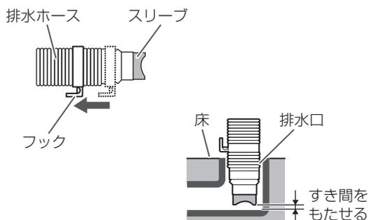
排水ホースは、排水時の水の力や振動などで動く場合がありますので、排水口にしっかり差し込み抜けなことを確認してください。
