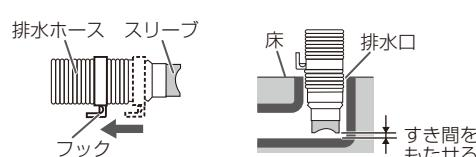
排水ホースは、排水時の水の力や振動などで動く場合がありますので、排水口にしっかり差し込み抜けないことを確認してください。
