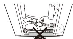
• 本体下の排水口に直接排水ホースを接続することは、内部の回転部品に接触し、ホースの破れや異常音の原因になりますので絶対におやめください。
