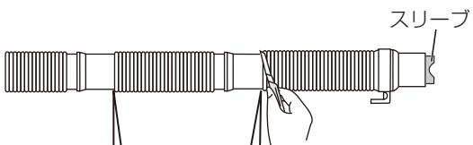
本体と排水口の距離に応じて、2カ所のうち、どちらかを切って先端にスリーブをはめ直してください。
