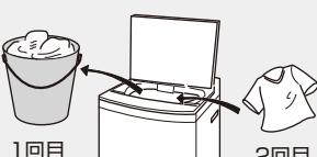
3 使用するコースと水量を設定し、「洗い→すすぎ→脱水」運転をする
