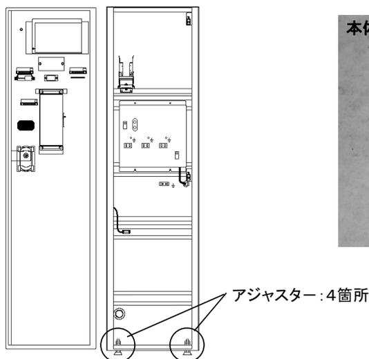
① 付属の設置カタガミを使用し、設置位置を決める。
