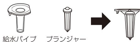
※給水パイプの取り付けは、給水パイプつまみを、給水タンク下にある溝に合わせてセットする。
