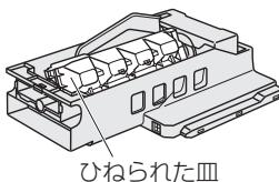
※製氷皿の付け忘れや、皿の取り付けがひねられていたり、逆だった場合、製氷しませんので、取り付けを確認してください。
