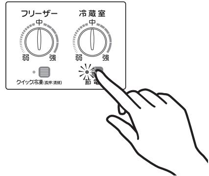
●節約ecoモード運転中は、設定温度よりも控えめな運転をし、節電に貢献します。冷えが弱いと感じたら、節約ecoモードを解除してください。
