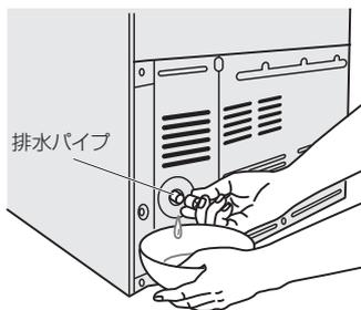
※排水後は、漏水しないようにキャップを確実に締める。
