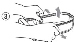
給水弁を反時計方向に回してははずす。
