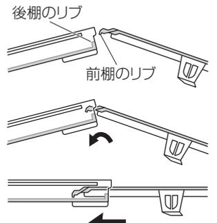
2 重ねた状態で、後棚左右の突起部を奥の溝に入れ水平に置く。
