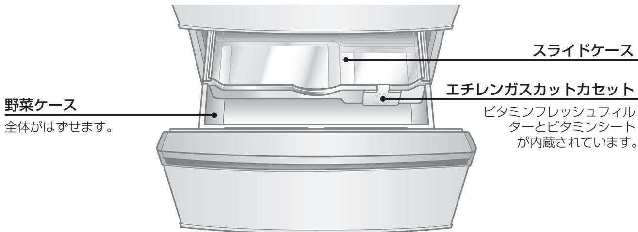
※エチレンガスカットカセットは交換不要です。破損の恐れがありますので、カセットは開けないでください。
