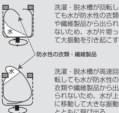
洗濯・脱水槽が高速回転しても水が防水性の衣類や繊維製品から出られないため、水が上に移動して大きな振動とともに飛び出る
