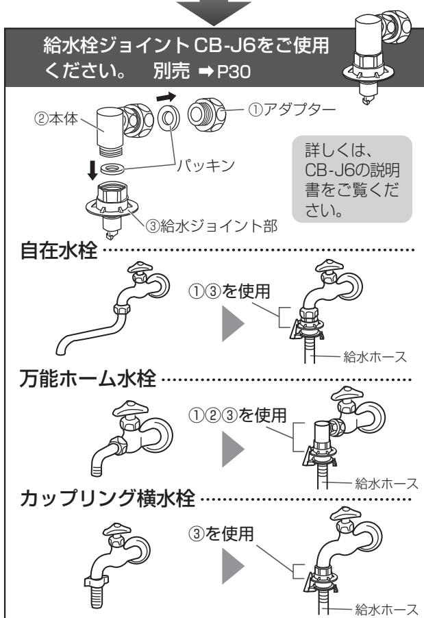
給水栓ジョイント(CB-J6)を使用する場合は、マジックつぎ手を取り付けず、直接給水ホースを取り付けてください。
