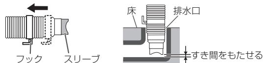
排水ホースは排水時の水の力や振動などで動く場合があるため、排水口にしっかり差し込み、抜けないことを確認してください。
