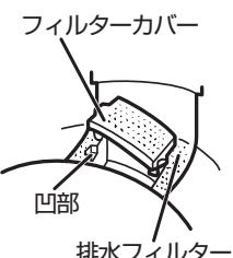
2 フィルターカバーを排水フィルターの形状に合わせ押し込む
