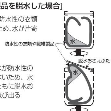
脱水槽が高速回転しても水が防水性の衣類や繊維製品から抜けないため、水が上に上がって大振動とともに脱水おさえふたを押し上げて、飛び出る
