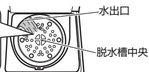
5 水栓を閉め、注水切換ツマミを「洗濯側」に合わせ、再び脱水タイマーを「1~2分」に合わせ、脱水する
