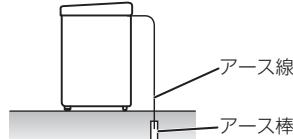
法令により電気工事士によるD種接地工事が
