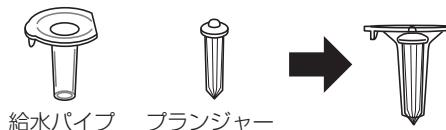
※給水パイプの取り付けは、給水パイプつまみを、給水タンク下にある溝に合わせてセットする。
