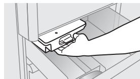
※自動製氷機は、氷ができると製氷皿をひねって氷を落とす動作をします。はずしたとき、製氷皿がひねられている場合は、いったん製氷ユニットを所定の位置に戻して、冷凍室扉を開め、製氷皿がまっすぐになるまで待ってから（約1分後）、製氷ユニットをはずす。
