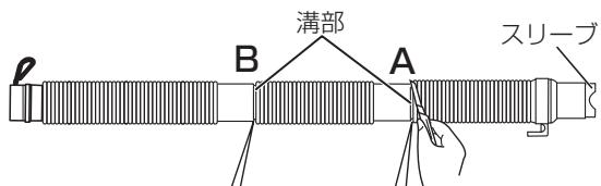
本体と洗濯パンなどの排水口の距離に応じて、溝部2カ所A・Bのうち、どちらかの溝部を切って先端にスリーブをはめ直してください。
