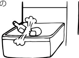
電源プラグの抜き差しは、必ず電源プラグを持って行う
