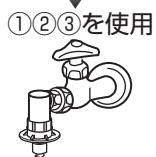
給水栓ジョイント(CB-J6)を取り付けた場合は、付属のマジックつぎ手を使用せず、直接給水ホースを取り付けてください。
