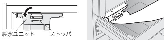
※自動製氷機は、氷ができると製氷皿をひねって氷を落とす動作をします。はずしたとき、製氷皿がひねられている場合は、いったん製氷ユニットを所定の位置に戻して、冷凍室（上）扉を開め、製氷皿がまっすぐになるまで待ってから（約1分後）、製氷ユニットをはずしてください。
