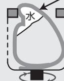
洗濯・脱水槽が高速回転しても水が防水性の衣類や繊維製品から抜けないため、水が上に移動して大振動とともに飛び出る
