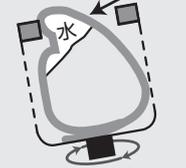
洗濯・脱水槽が高速回転しても水が防水性の衣類や繊維製品から抜けないため、水が上に移動して大振動とともに飛び出る
