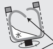
洗濯・脱水槽が回転しても水が防水性の衣類や繊維製品から抜けないため、水が片寄って大振動を引き起こす
