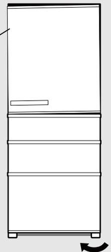
転倒防止用のベルトをかける背面のフックにベルトを通して、壁や柱に固定する
