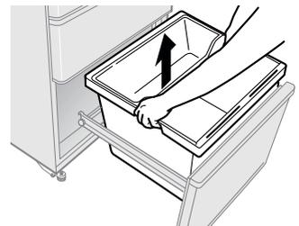
■野菜室をはずす場合は、先に冷凍室(下)をはずしてください。バスケットと野菜ケースは左右のレールを持って同時にはずしてください。
