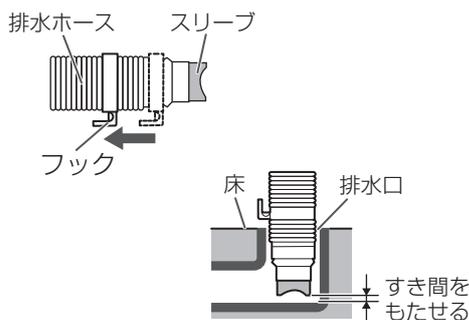
排水ホースは、排水時の水の力や振動などで動く場合がありますので、排水口にしっかり差し込み抜けにくいことを確認してください。
