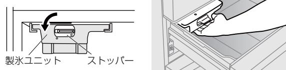
※自動製氷機は、氷ができると製氷皿をひねって氷を落とす動作をします。はずしたとき、製氷皿がひねられている場合は、いったん製氷ユニットを所定の位置に戻して、冷凍室扉を閉め、製氷皿がまっすぐになるまで待ってから（約1分後）、製氷ユニットをはずしてください。
