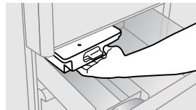
※自動製氷機は、氷ができると製氷皿をひねって氷を落とす動作をします。はずしたとき、製氷皿がひねられている場合は、いったん製氷ユニットを所定の位置に戻して、冷凍室扉を開め、製氷皿がまっすぐになるまで待ってから（約1分後）、製氷ユニットをはずしてください。
