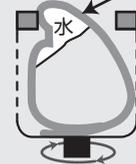
洗濯・脱水槽が高速回転しても水が防水性の衣類や繊維製品から抜けなため、水が上に移動して大振動とともに飛び出る
