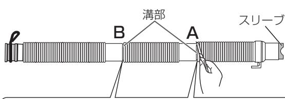
本体と洗濯パンなどの排水口の距離に応じて、溝部2カ所A・Bのうち、どちらかの溝部を切って先端にスリーブをはめ直してください。
