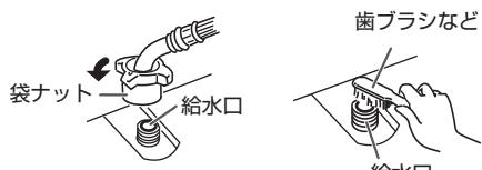
5 袋ナットを傾きのないよう確実に締め付ける
