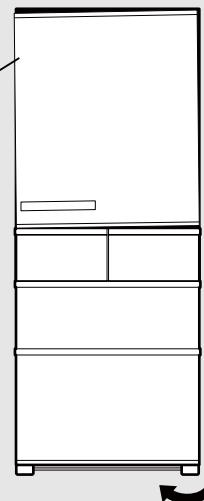
転倒防止用のベルトをかける背面のフックにベルトを通して、壁や柱に固定する
