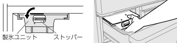
※自動製氷機は、氷ができると製氷皿をひねって氷を落とす動作をします。はずしたとき、製氷皿がひねられている場合は、いったん製氷ユニットを所定の位置に戻して、アイスルームの扉を閉め、製氷皿がまっすぐになるまで待ってから（約1分後）、製氷ユニットをはずしてください。
