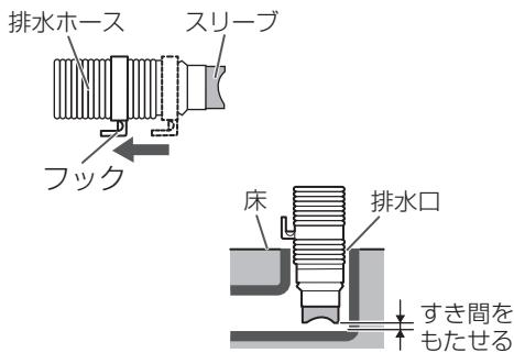
排水ホースは、排水時の水の力や振動などで動く場合がありますので、排水口にしっかり差し込み抜けないことを確認してください。
