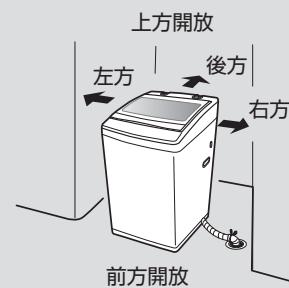
※排水ホース接続側は、壁から8cm以上、真下排水パイプを使用した場合、排水ホース側は壁から15cm以上
