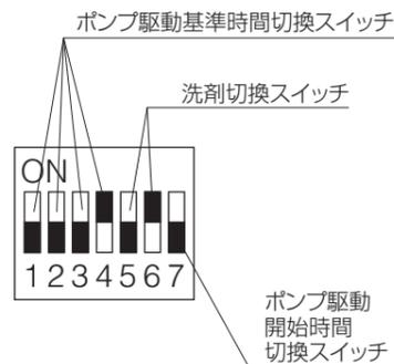
①「ポンプ駆動基準時間切換スイッチ」をセットします。スイッチ1、2、3、4の組み合わせにより、ポンプ駆動時間を切り換えることができます。(表-1参照) 洗剤の種類により、駆動時間を微調整し、規定量入るようにセットします。
