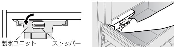
※自動製氷機は、氷ができると製氷皿をひねって氷を落とす動作をします。はずしたとき、製氷皿がひねられている場合は、いったん製氷ユニットを所定の位置に戻して、冷凍室（上）扉を開め、製氷皿がまっすぐにになるまで待ってから（約1分後）、製氷ユニットをはずしてください。
