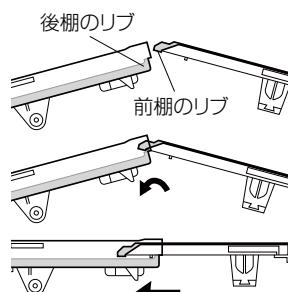
2 重ねた状態で、後棚左右の突起部を奥の溝に入れ水平に置く。
