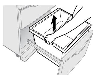
■野菜室をはずす場合は、先に冷凍室（下）をはずしてください。バスケットと野菜ケースは左右のレールを持って同時にはずしてください。
