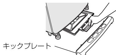
4 3ページを参考にして、左右の調節脚を床から浮かせ車輪を床に着ける。
