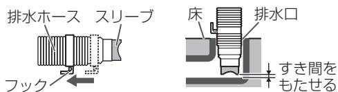
排水ホースは、排水時の水の力や振動などで動く場合がありますので、排水口にしっかり差し込み抜けないことを確認してください。
