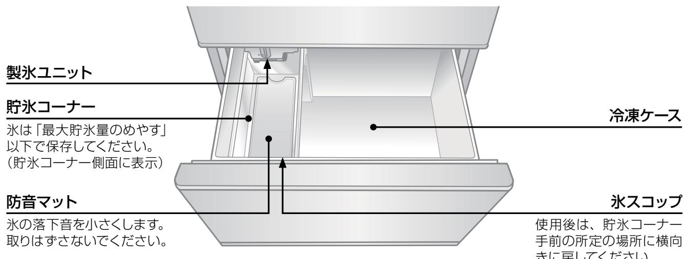
※食品収納スペースの目安(21ページ)は防音マットと氷スコップを取りはずして算出しています。
